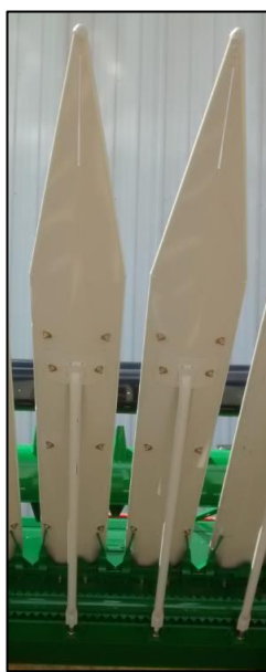
Фигура: : (А) - тави с прави ръбове, с по-голямо триене и вероятност за счупване на стъблото (В) - тави със заоблени ръбове с по-малко триене и значително по-малка вероятност за счупване на стъблото
